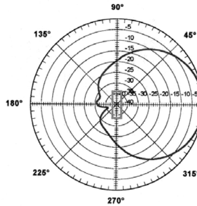
Azimutdiagramm der verwendeten Antenne K 735 147
